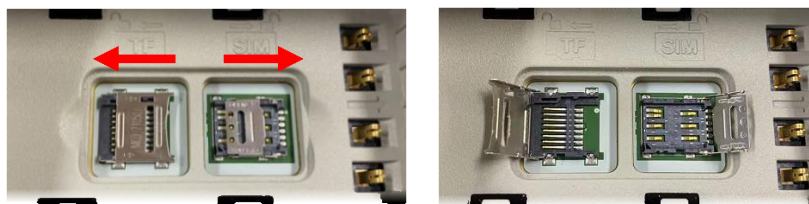
図 8 SD カードスロットと SIM カードスロット
