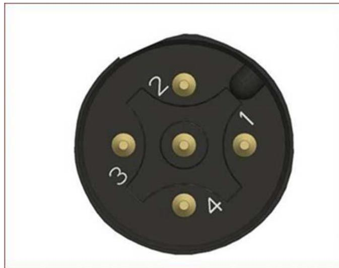
図2-6：5ピン（オス）CANポートのピン出力
